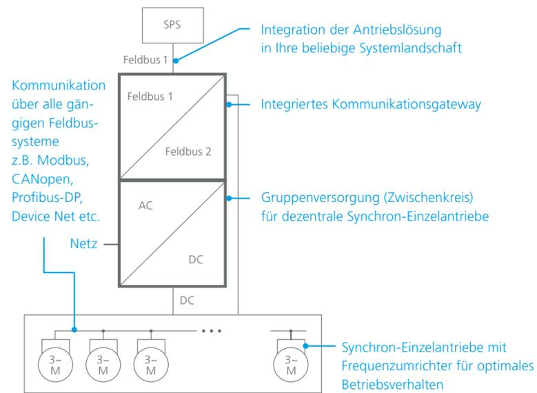
**Einsatzgebiete:** Dezentrale Antriebskonzepte eignen sich insbesondere für Trommelmotoren, Galettenantriebe, Einzelantriebe u. v. m.
