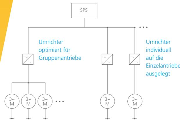
**Einsatzgebiete:** Für Textilmaschinen mit zentralem Antrieb und mechanischer Kraftübertragung an einzelne Wickler u. v. m.
